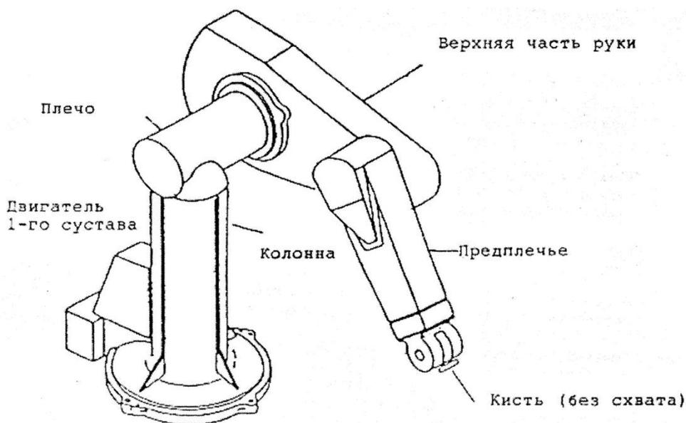
составные части и подвижные соединения робота-манипулятора
